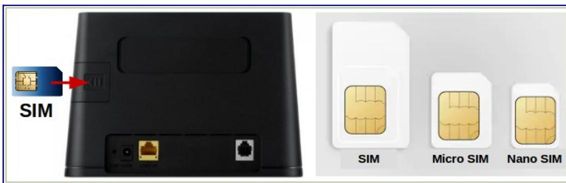
■ Inserire la **SIM Card** nel **Modem Router 4G**. Ogni modem router ha un alloggiamento diverso per inserire la SIM Card, è comunque sempre indicato nelle istruzioni. Nel modem router che utilizzo, bisogna ridurla a Micro SIM agendo delicatamente per staccarla dai leggeri intagli che permettono di avere le dimensioni desiderate. Per inserirla nel modem router si deve aprire il cassetto e rispettare il verso indicato.
