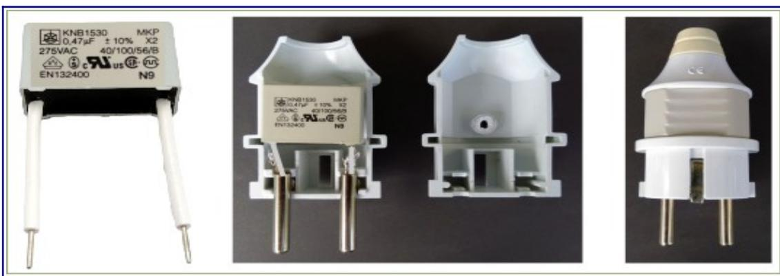
rete. Prendetelo con fili un po' lunghi così da evitare saldature. Inserite le due uscite nei due poli di una **spina volante shuko** in cui avrete fatto spazio tagliando il perno porta vite, stringendo bene le viti. Chiudete la spina avvolgendola con del nastro isolante da elettricisti. Questo filtro artigianale va inserito in una ciabatta elettrica a valle del dispositivo che crea interferenze, così da proteggere il Powerline.
