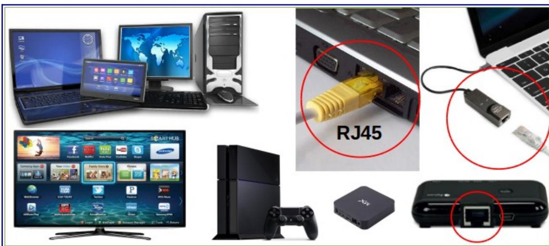
**videogiochi, ecc., provvisti di una porta RJ45**, chiamata anche **porta di rete Ethernet**. Esistono anche adattatori per portatili che non siano provvisti di porta RJ45.
