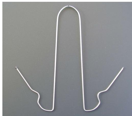
Piegare nei punti indicati fino a portare le alette perpendicolari. Se ci si aiuta con una morsa da banco si ottiene una piegatura migliore.
